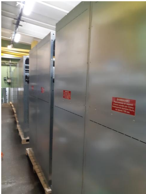
Клапаны сброса давления в верхней и средней части задней стенки
